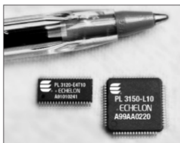
Σχήμα 4.2: Πομποδέκτες PL3120 και PL3150
