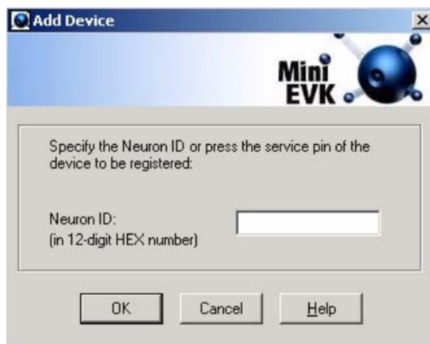
Σχήμα 8.15: Σύνδεση του Monitor με το PL3120 Neuron Chip
